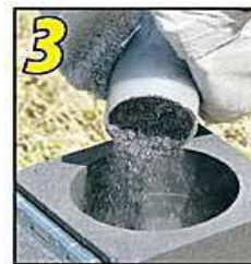
3 Pour powder into crucible.
